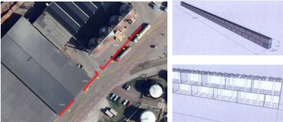
Figur 5. Påkörningsskydd utmed lager för ammoniumnitrat.
