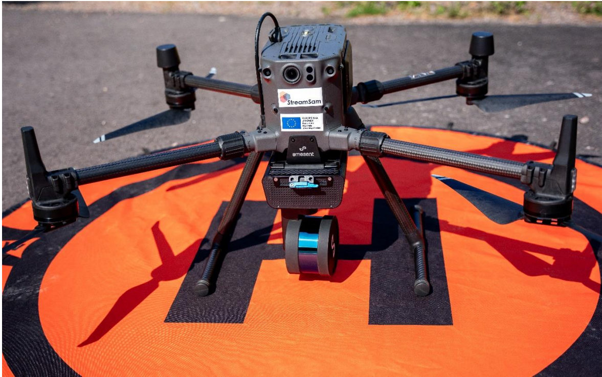
DJI Matrice 300 med Emesents Hovermap VF1 monterad
