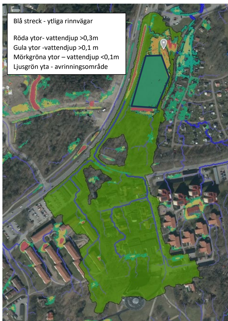
Figur 8. Avrinningsområde och översvämmad mark vid 100 mm regn. Ny planlagd yta med kvartersmark har höjts i terrängmodellen.
