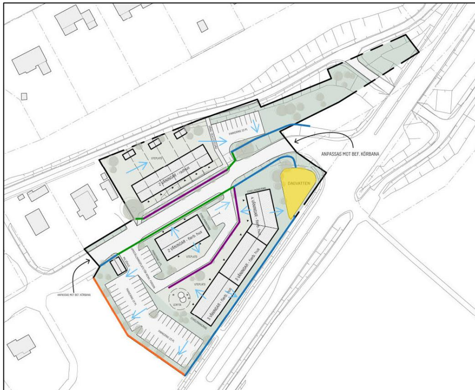
Figur 6: Föreslagna översiktlig hantering av dagvatten inom planområdet. Orange: avskärande dike. Mörkblå: befintliga diken som behöver utökas/modifieras. Lila: makadamdike/svackdike. Gul: föreslagna placering av torrdamm. Grönt: Ledning/trumma. Ljusblå pilar visar önskad avrinning. Ytor efter arbetsdokument av illustrationsplan 2022-03-17 och gatusektion 2022-06-28.
