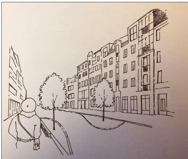
Principskiss över hur en avsmalning av vägbanan kan gestaltas i kombination med plantering av uppstammat gatuträd.
