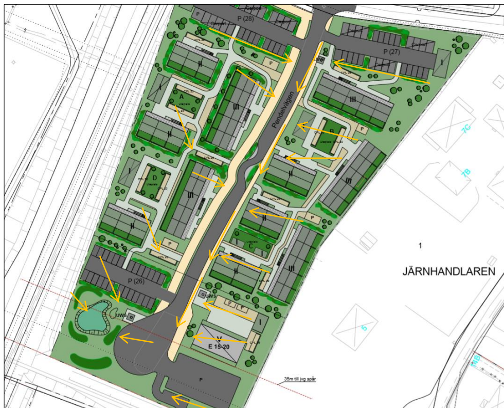
Ett exempel på flödesvägar vid större regn enligt Swecos dagvattenutredning, daterad 2018-12-07, rev 2020-04-14.
